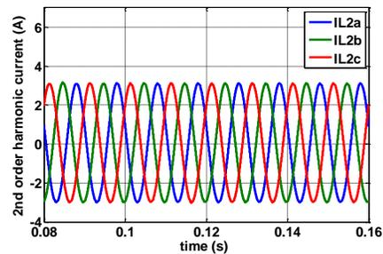
(d) 2<sup>nd</sup> order harmonic components of three-phase output current
